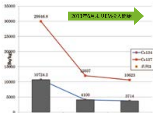
図1. 伊達市梁川町長沼の底質（底泥）における放射性Cs濃度の推移
